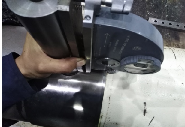
Copiando la inclinación del segundo alojamiento con el clinómetro
