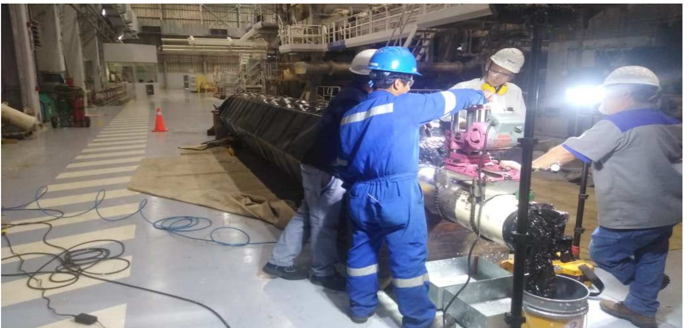
Proceso de maquinado en el eje, al lado de la máquina en el centro de producción ...
