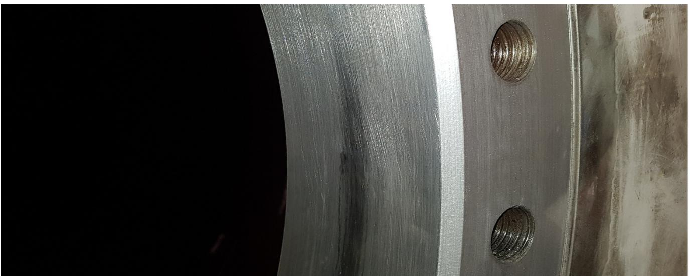
Detalle del acabado obtenido (barrenado y refrentado)
