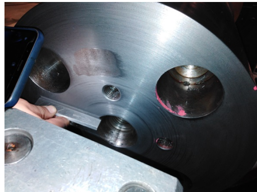
Revisión de la planitud en la hendidura
