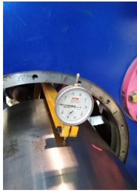
Portareloj para el alineamiento, luego centrando el soporte exterior
