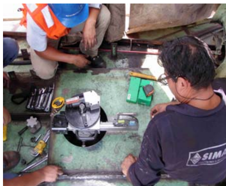
Nivelación con clinómetro
