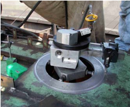
Maquinando el asiento de la válvula Fuente: P3120495.JPG
