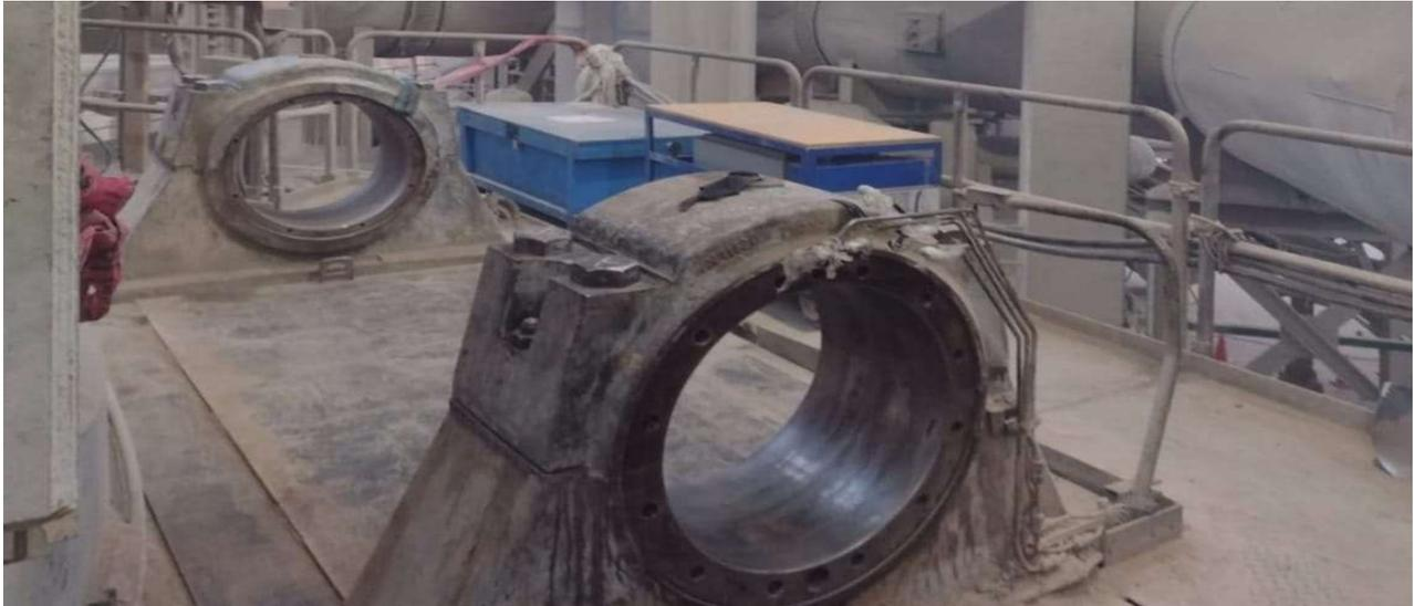
Los 2 alojamientos de cada una de las 3 chumaceras de los balancines (rocker arm) de un molino LOESCHE de una fábrica de cemento estaban desgastados y tenían que ser rellenados primero con soldadura, para luego mandrinarlos y regresarlos a las dimensiones originales.
