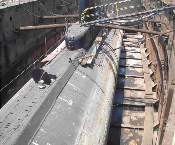
Luego del exitoso trabajo en un primer submarino (ver reporte 009811.BB-04), se nos encargó maquinar en un segundo submarino el tubo de codaste (el alojamiento más próximo a la sala de máquinas del eje que acciona la hélice) que presentaba ingreso de agua y que tenía que ser reparado – un trabajo que sólo puede ser hecho en sitio
