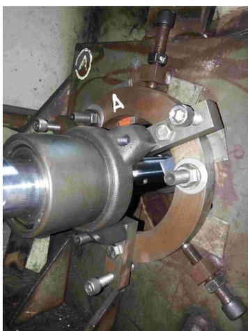
Utiliza rodamientos rígidos de bolas (no autoalineantes), además de pernos, laines, fierritos, etc. que además de reducir la estabilidad del soporte, demoran el proceso de montaje (hasta aquí se habían demorado 10 días !)
