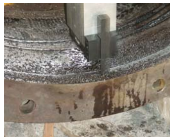
Fuente: P1311813 y 14.JPG Maquinando la superficie
