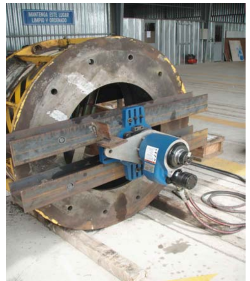
Fuente: P2021854 .JPG Lado motriz, con motor hidráulico
